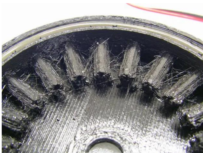
Рисунок 1.7 – Волосатость или паутинка на готовой модели
