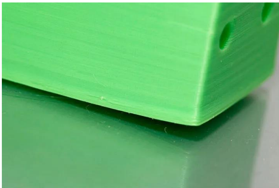
Рисунок 1.2 – Модель отклеивается от печатного стола или не липнет к нему
